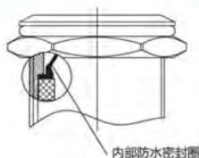
内部IP防尘、防水结构
