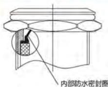
内部IP防尘、防水结构
