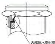
内部IP防尘、防水结构
