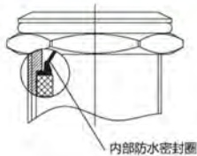
内部IP防尘、防水结构
